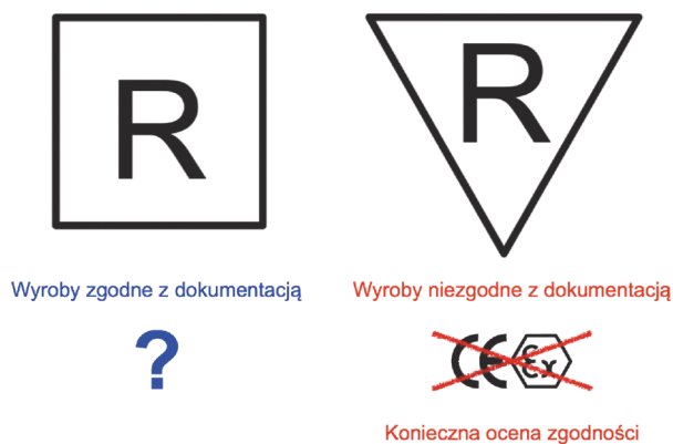
Rys. 7. Oznakowanie wyrobów po naprawie według IEC 60079-19 symbolem R w kwadracie lub w trójkącie (urządzenia elektryczne). Po lewej wyrób zgodny z pierwotną dokumentacją, po prawej wyrób niezgodny z pierwotną dokumentacją (konieczna dalsza ocena)
