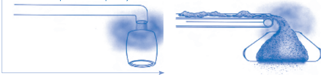
Rysunek 2.2: Przykłady dotyczące powstawania mieszanin pył/powietrze podczas operacji napełniania i transportowych 5 .
