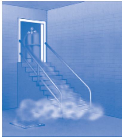
Rysunek 2.3: Rozprzestrzenianie się skroplonych gazów (przykład) 6
