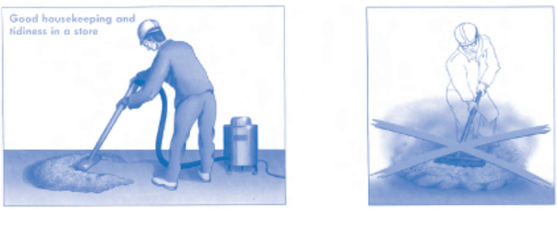
Rysunek 3.2: Usuwanie osadów pyłu 9 .
