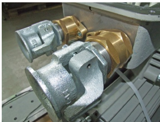
Rysunek 1: Ognioszczelne wpusty kablowe w urządzeniu zamontowane na czas transportu (odwrócone noski mocownika).
