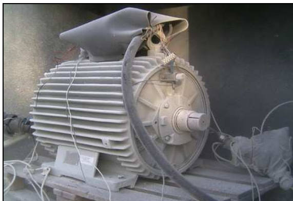
Fot. 4. Silnik w komorze niskich temperatur
