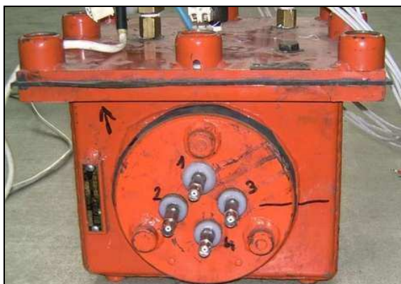
Fot. 2. Skrzynka testowa. Widoczne czujniki ciśnienia
