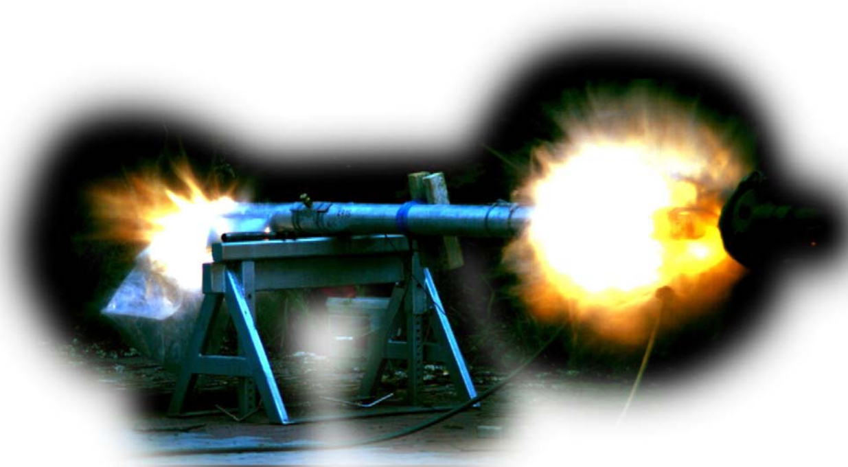
Rys. 3. Badanie przerywacza płomienia (wynik negatywny)
