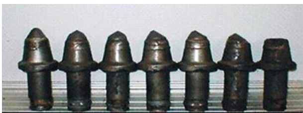
Rys. 5. Zużyte noży urabiających [3].
